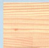
積層材は小さなピースを貼り合わせた後、削って平滑を出し240番程度サンダーにて仕上げをしています。
